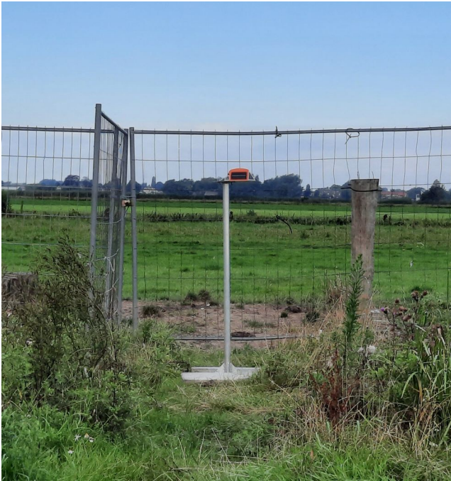
Basis moet hoger of verder van het hek af staan Deze zakbaak mag niet in het verzakkings-gebied staan
